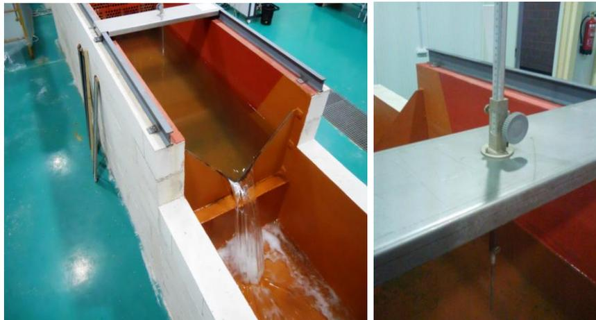
**Figura 28: Izquierda, Aforo mediante vertedero triangular; Derecha, detalle del limnómetro.**
