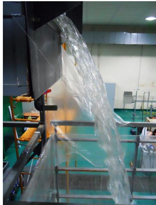
**Figura 178: Izquierda, detalle aguas abajo del aliviadero; derecha, detalle del perfil del chorro.**
