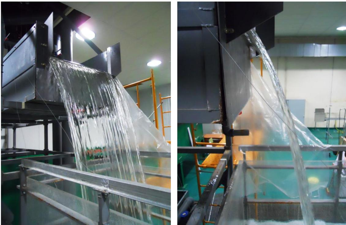
**Figura 152: Izquierda, detalle aguas abajo del aliviadero; derecha, detalle del perfil del chorro.**
