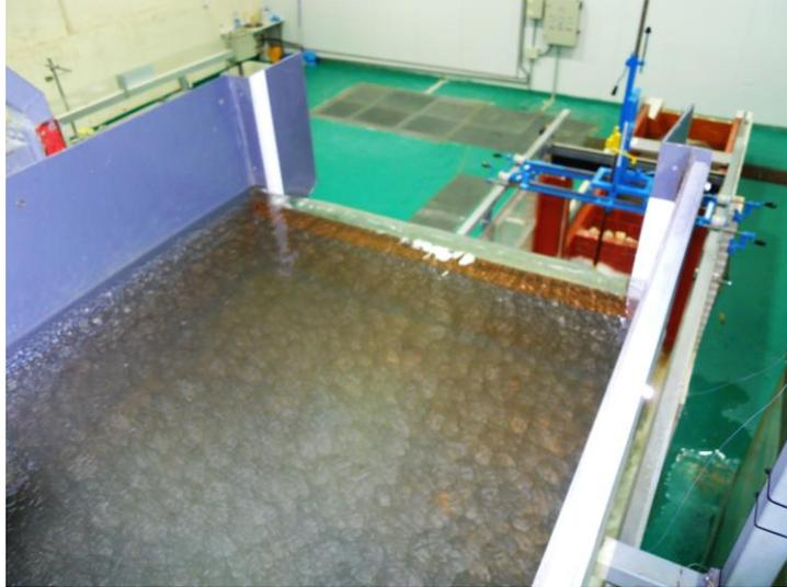
**Figura 177: Detalle aguas arriba del aliviadero.**
