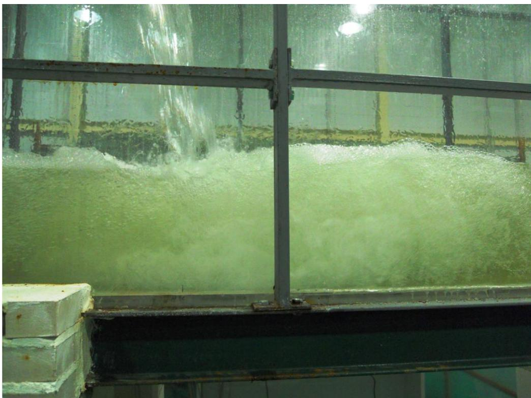
**Figura 182: Detalle del resalto hidráulico.**
