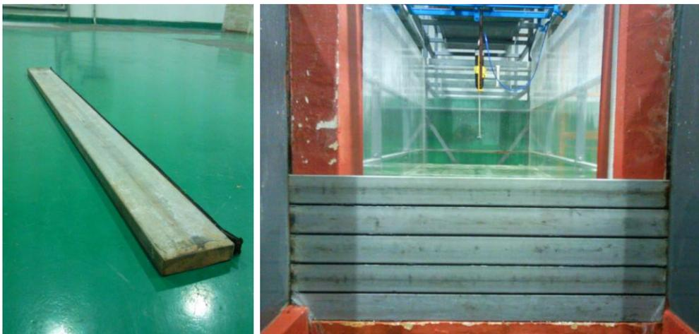
**Figura 26: Izquierda, detalle de una barrera; Derecha, contrapresa en la salida del cuenco de 5 barreras.**
