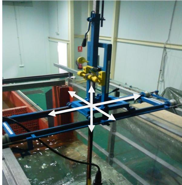
**Figura 27: Soporte mecánico empleado en la toma de datos.**
