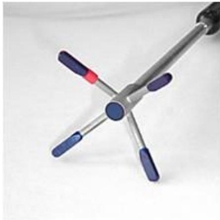
**Figura 37: Elemento sensor de la sonda ADV Vectrino.**
