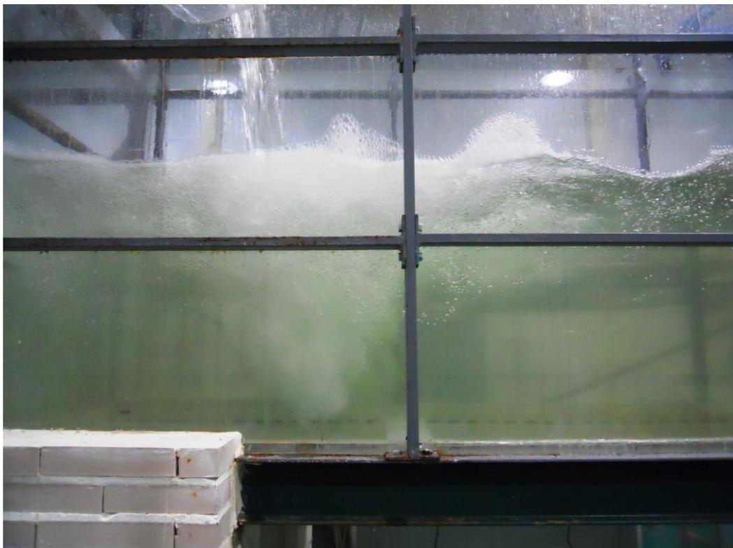
**Figura 176: Detalle del resalto hidráulico.**
