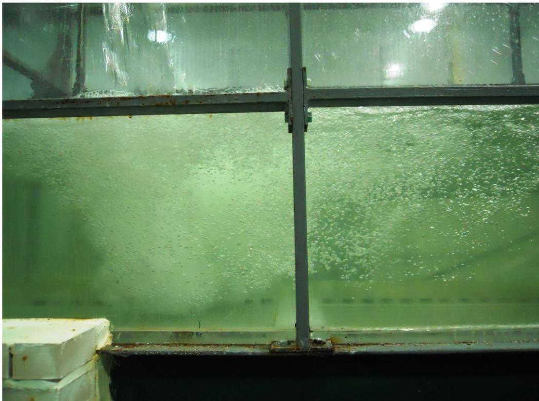
**Figura 158: Detalle del resalto hidráulico.**
