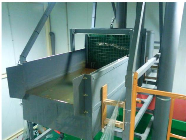
**Figura 24: Cajón superior que constituye el vertedero de labio fijo.**
